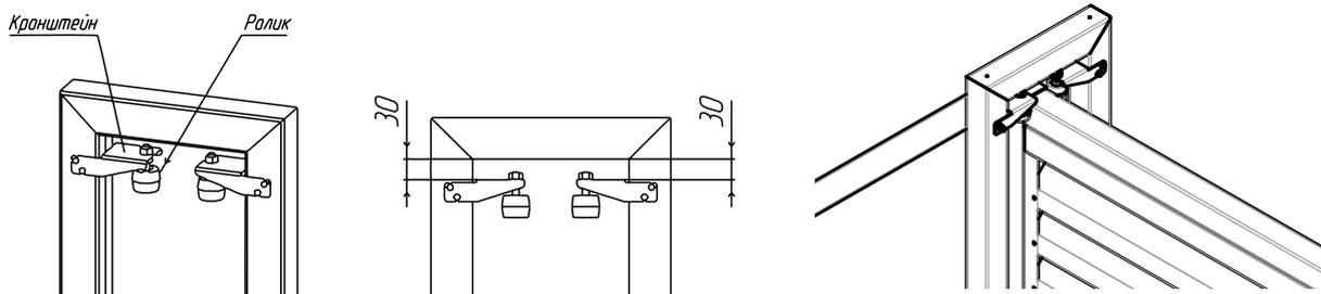
Далее на установленные роликовые опоры устанавливаются собранные откатные ворота. Затем производится регулировка поддерживающих роликов и их фиксация.
