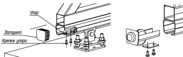
Затяжка болтов упора и опорного ролика производится согласно моменту затяжки для применяемой резьбы по ГОСТ – 12 – 15 Н·м.
